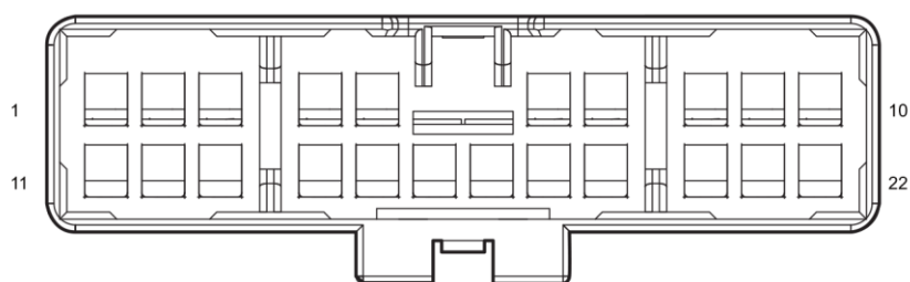
I1_BT اتصال سوکت دسته سیم 1 بدنه با دسته سیم درب پشت
