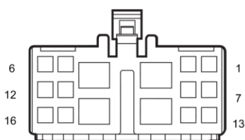
M05 جعبه فیوز داخل اتاق M
