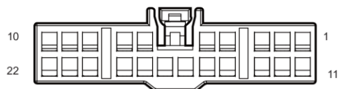
I1_BM اتصال سوکت دسته سیم 1 بدنه با دسته سیم اصلی
