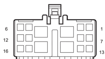
M05 جعبه فیوز داخل اتاق M
