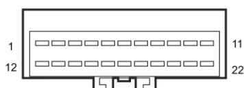
I1_MR اتصال سوکت دسته سیم 1 اصلی با دسته سیم سقف
