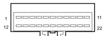
I1_MR اتصال سوکت دسته سیم 1 اصلی با دسته سیم سقف
