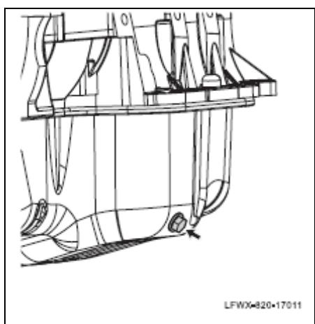
(b) پیچ تخلیه روغن را بسته و سفت کنید.
