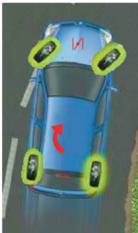
مثال از عملیات تنظیم ESP
