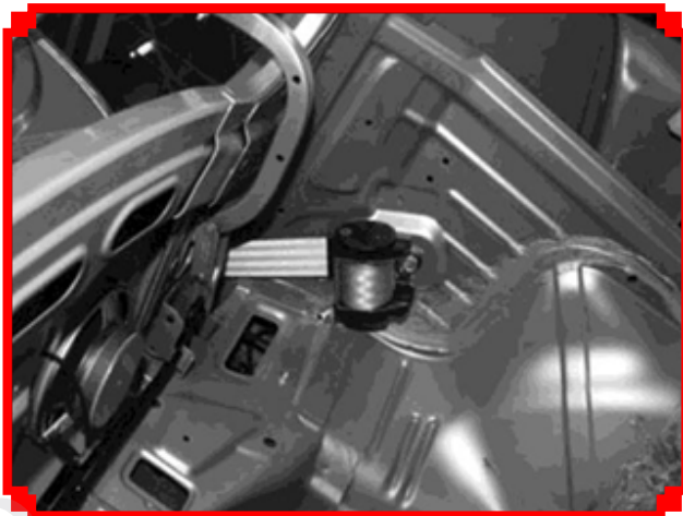
۷) پیچ محکم کننده سمت بالای کمر بند ایمنی را باز کنید.
