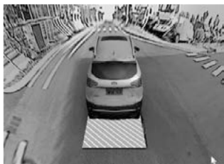
تصویر 9، تصویر از جلوراست و در حالت گردش به چپ است، دنده دنده در موقعیت دنده عقب قرار ندارد.
