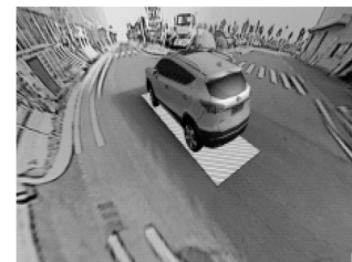
تصویر ۹، تصویر سه‌بعدی عقب چپ و گردش به چپ است، دسته دنده در موقعیت دنده عقب قرار ندارد
