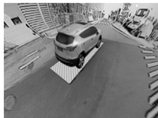
تصویر ۹، تصویر سه‌بعدی عقب راست و گردش به چپ است و دسته دنده در موقعیت دنده عقب قرار ندارد
