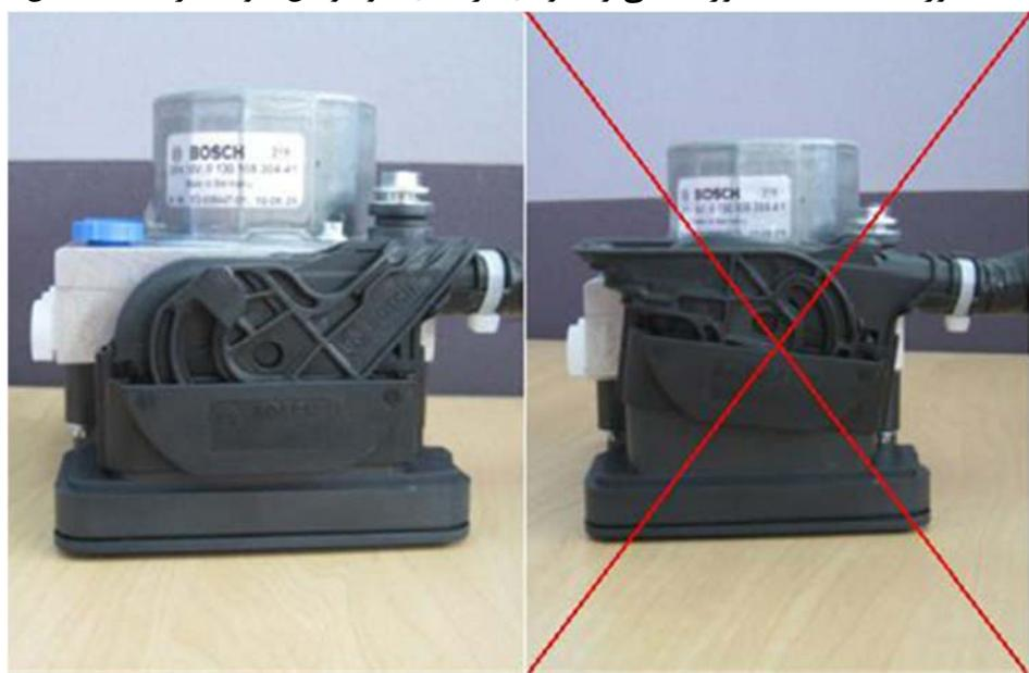
هنگام اتصال لوله ترمز ESP از صحت اتصالات اطمینان حاصل کنید. ECU واحد ESP نمی تواند در مورد نصب صحیح اتصالات لوله ترمز کنترل داشته باشد و ایرادات آن را تشخیص دهد.
